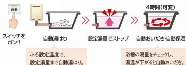
※残り湯が循環口より上にある場合は、設定湯量まで湯はりしますが、残り湯が循環口より下にある場合は、残り湯+設定湯量で湯はります。なお残り湯が循環口より上にある場合でも、残り湯の温度または湯量がリモコンの設定値に近い場合は約6リットルだけ湯はりし、設定した量になりません。
